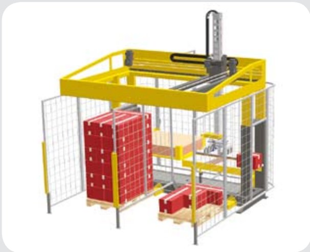
Double pallet station and slip sheet magazine Doble palet y almacén inserción planchas
