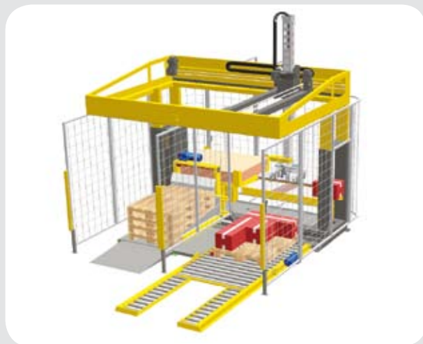
Conveyor for full pallets, automatic pallet and slip sheet magazines Transportador a rodillos de toma palet llenos, almacén automático palet y almacen planchas
